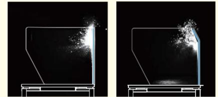
※効果は当社調べ(口元の高さで水平に霧吹きを噴射、パネル衝突後の飛沫の流れを比較)
